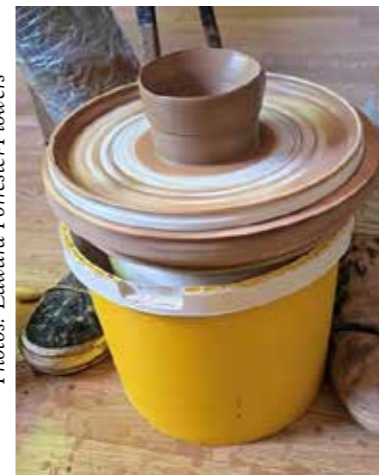
Ed’s converted ceiling fan wheel
